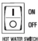
Установите выключатель нагрева воды в положение ON. На передней панели загорится индикатор нагрева горячей воды (красный). При нагревании в аппарате может возникать легкий шум, это нормальное явление.
